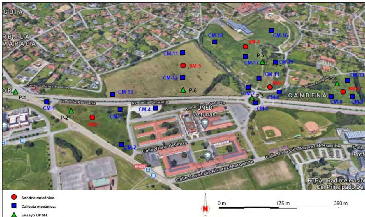
Localización, dentro de la zona de estudio, de las calicatas mecánicas realizadas (CM, en azul), ensayos DPSH (P, en verde) y sondeos mecánicos (SM, en rojo).
