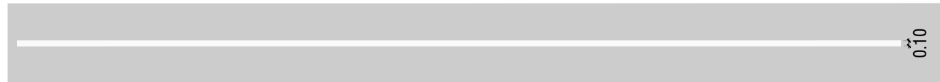
M-2.6 LÍNEA CONTINUA BORDE DE CALZADA. ARCÉN < 1.5m VÍAS VM \leq 100 km/h
