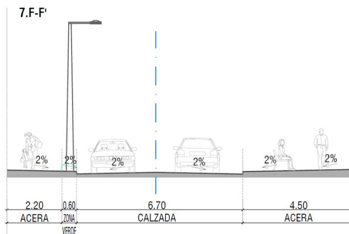
Los viales con dos sentidos de circulación (eje 1 y 7) contarán con una anchura total de calzada de 6,40 m, mientras que los carriles con un único sentido de circulación contarán un ancho total de 3,20 m. Exceptuando el eje 6 y las playas de aparcamiento, que se encontrarán al mismo nivel, existirá un desnivel de 10 cm entre acera y calzada.
