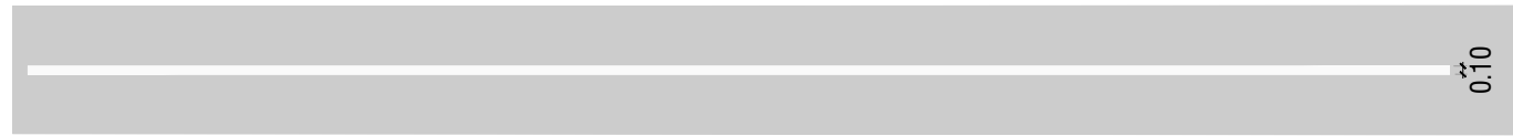
M-2.6 LÍNEA CONTINUA BORDE DE CALZADA. ARCÉN < 1.5m VÍAS VM \leq 100 km/h
