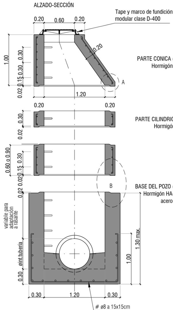
PARTE CONICA (prefabricada)
