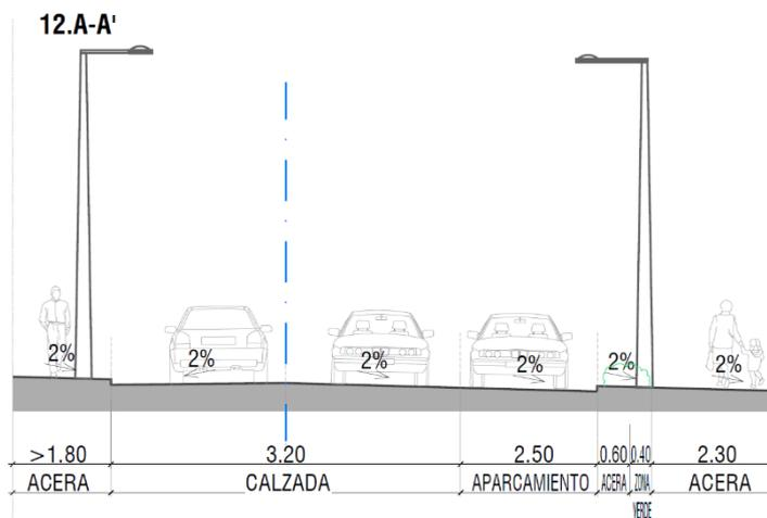
Los viales con dos sentidos de circulación (ejes, 7, 8, 9, 11, 12) contarán con una anchura total de calzada de 6,40 m, mientras que los carriles con un único sentido de circulación contarán un ancho total de 3,20 m. Exceptuando los ejes 5 y 10 y las playas de aparcamiento, existirá un desnivel de 10 cm entre la acera y la calzada.
