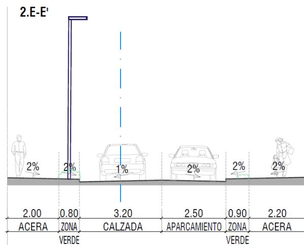
Los viales con dos sentidos de circulación (ejes 1, 7, 8, 9, 11, 12 y un tramo del eje 2) contarán con una anchura total de calzada de 6,40 m, mientras que los carriles con un único sentido de circulación contarán un ancho total de 3,20 m. Exceptuando los ejes 5, 6 y 10 y las playas de aparcamiento, la calzada se encontrará 10 cm por debajo de la cota de la acera.
