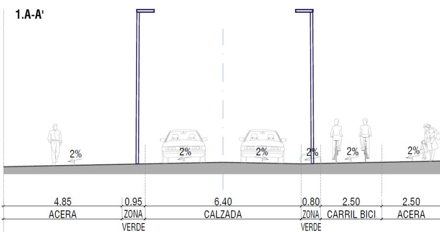
Las separaciones de cada elemento de sección se efectuarán mediante:
