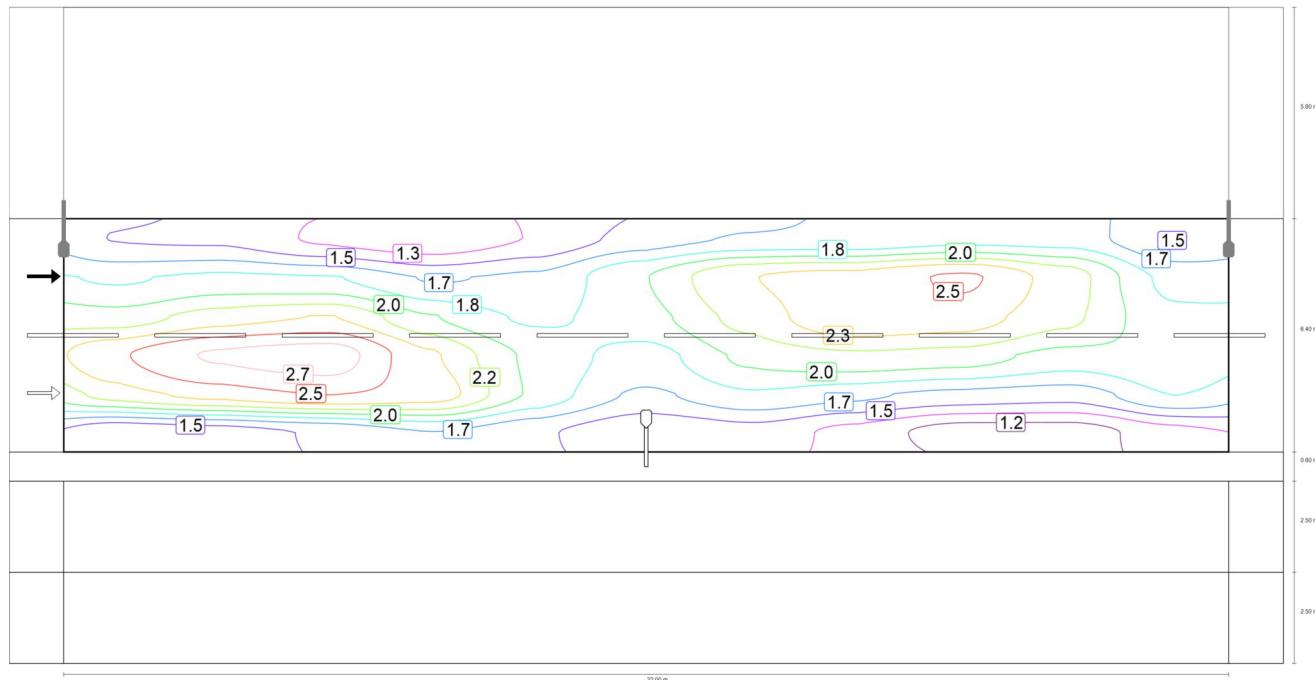
Observador 2: Valor de mantenimiento luminancia en calzada seca [cd/m<sup>2</sup>] (Líneas Isolux)
