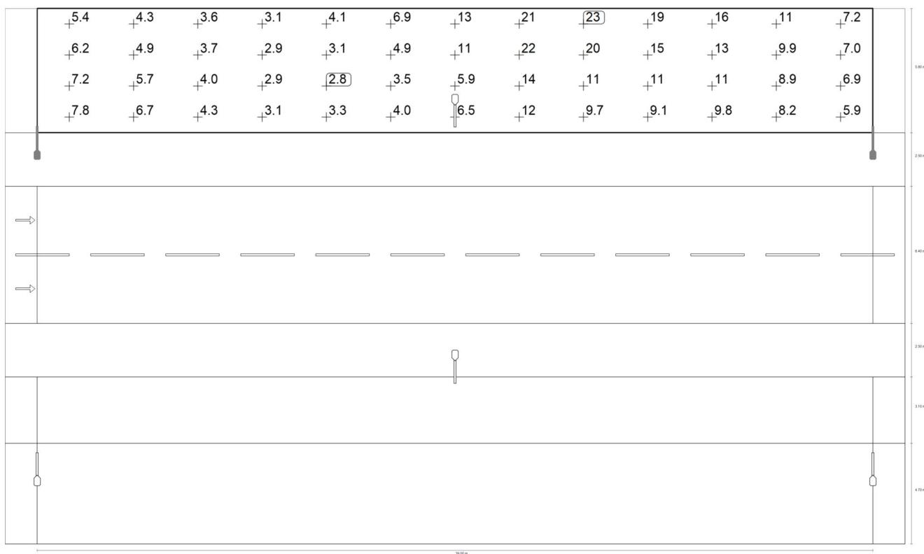
Valor de mantenimiento iluminancia semicilíndrica (oeste) [lx] (Sistema de valores)
