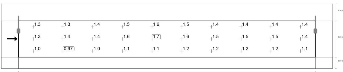
Observador 1: Valor de mantenimiento luminancia en calzada seca [cd/m<sup>2</sup>] (Sistema de valores)
