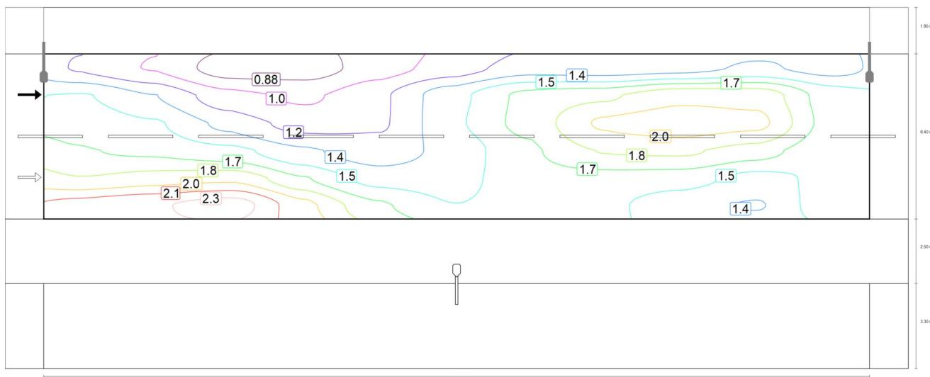
Observador 2: Valor de mantenimiento luminancia en calzada seca [cd/m<sup>2</sup>] (Líneas Isolux)
