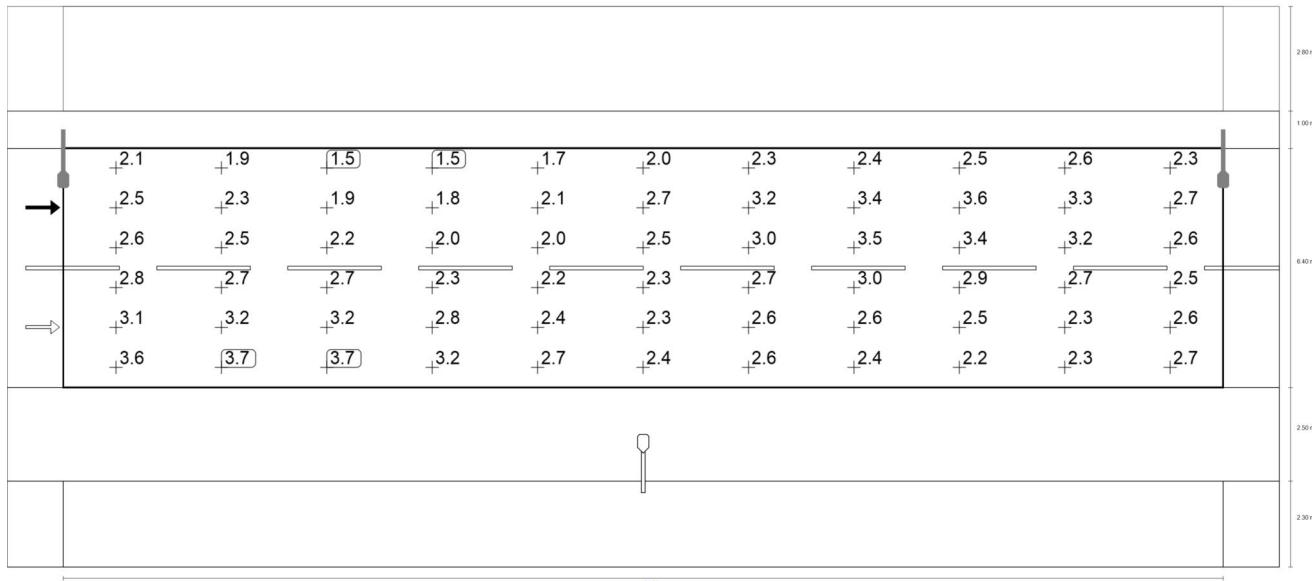
Observador 2: Luminancia para una instalación nueva [cd/m<sup>2</sup>] (Sistema de valores)
