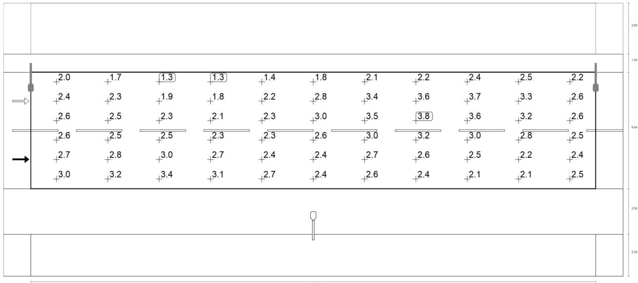
Observador 1: Luminancia para una instalación nueva [cd/m<sup>2</sup>] (Sistema de valores)
