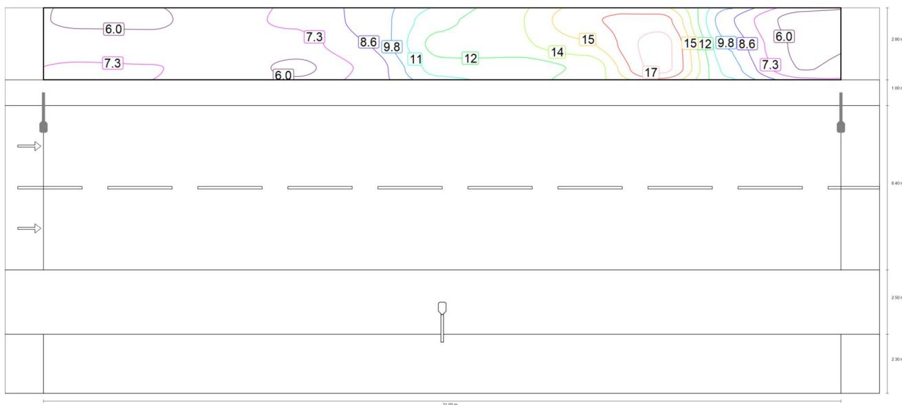
Valor de mantenimiento iluminancia semicilíndrica (oeste) [lx] (Líneas Isolux)
