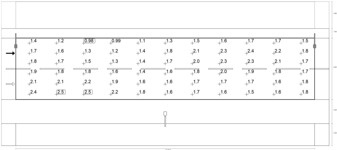
Observador 2: Valor de mantenimiento luminancia en calzada seca [ $\text{cd}/\text{m}^2$ ] (Sistema de valores)
