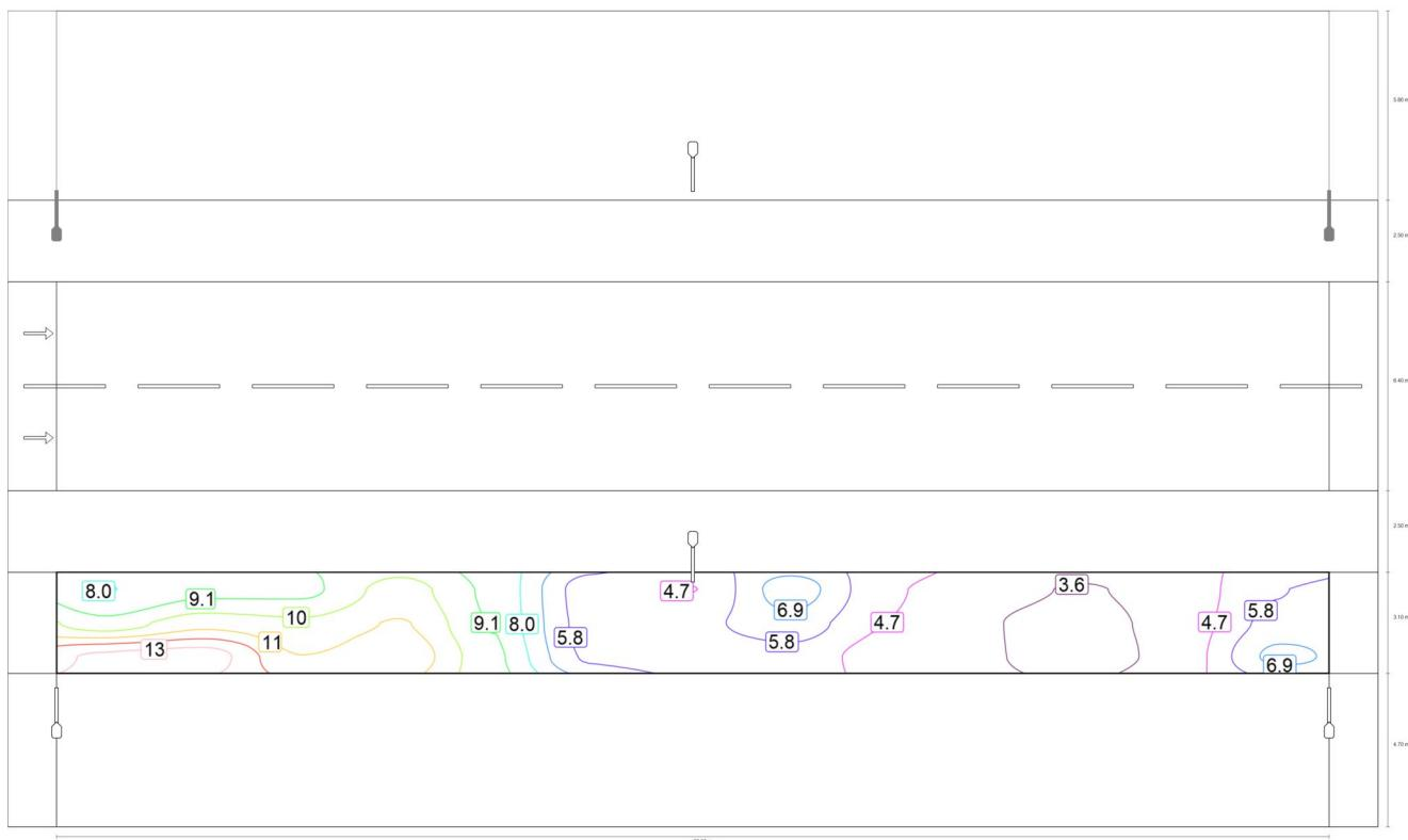
Valor de mantenimiento iluminancia semicilíndrica (oeste) [Ix] (Líneas Isolux)
