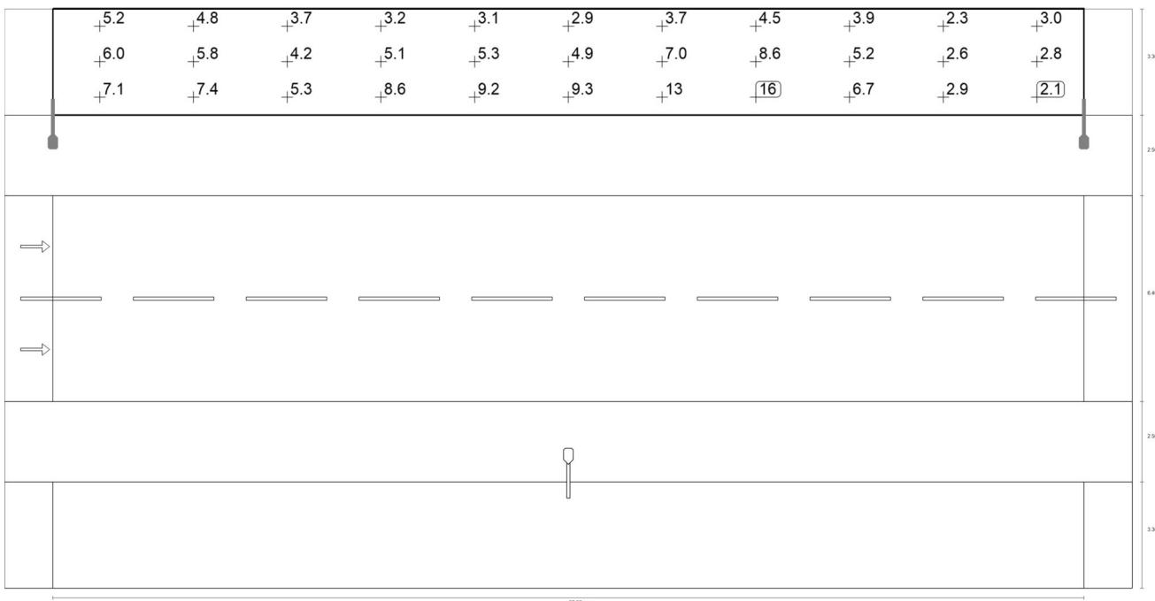
Valor de mantenimiento iluminancia semicilíndrica (oeste) [lx] (Sistema de valores)
