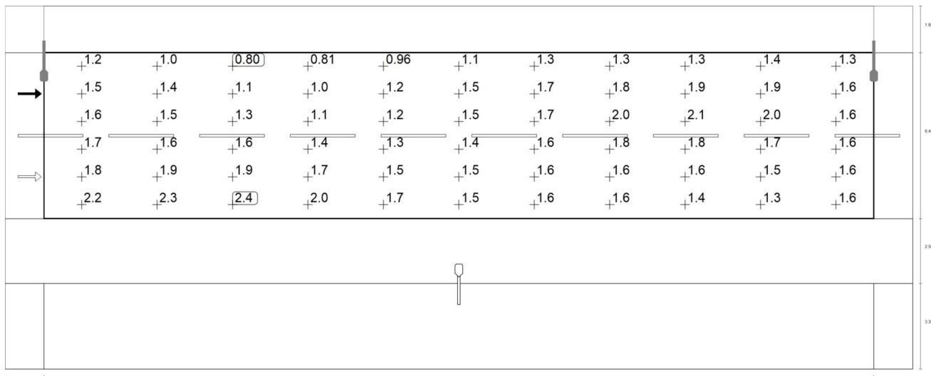
Observador 2: Valor de mantenimiento luminancia en calzada seca [cd/m<sup>2</sup>] (Sistema de valores)
