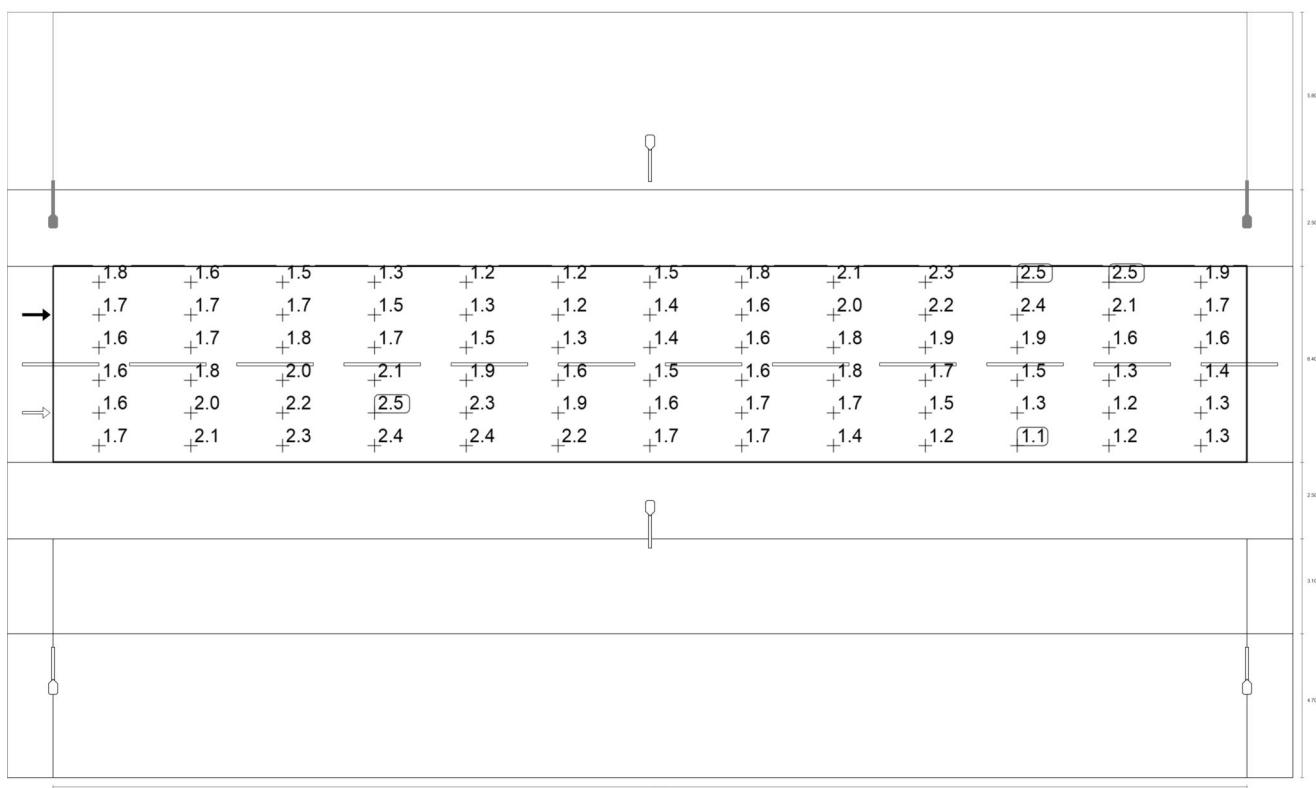
Observador 2: Luminancia para una instalación nueva [cd/m<sup>2</sup>] (Sistema de valores)
