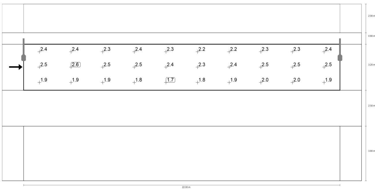
Observador 1: Luminancia para una instalación nueva [cd/m<sup>2</sup>] (Sistema de valores)
