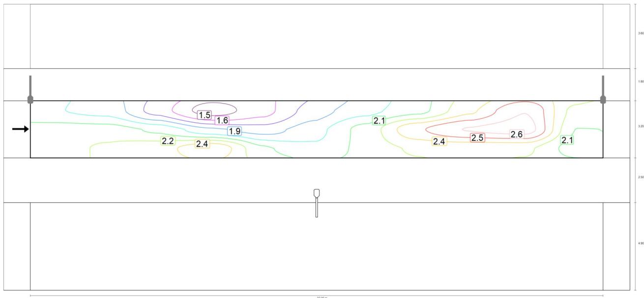
Observador 1: Valor de mantenimiento luminancia en calzada seca [cd/m<sup>2</sup>] (Líneas Isolux)
