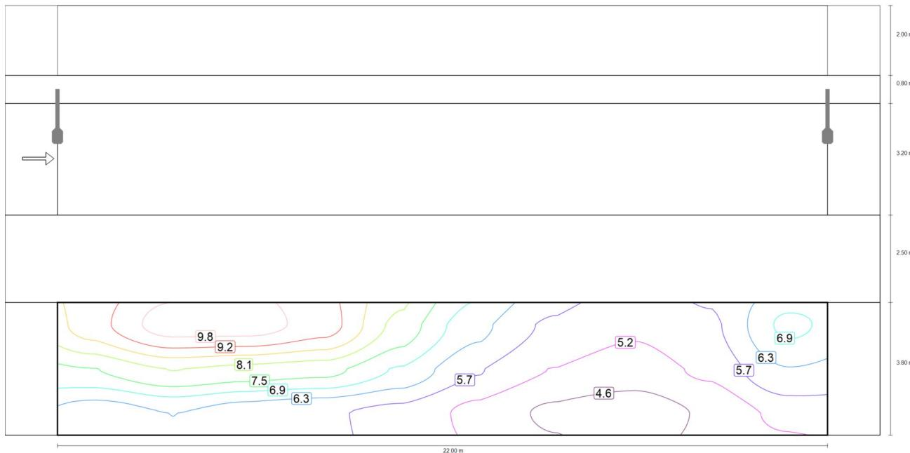
Valor de mantenimiento iluminancia semicilíndrica (oeste) [ $I_x$ ] (Líneas Isolux)
