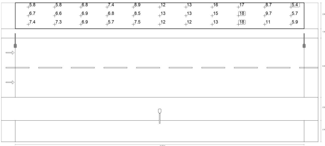
Valor de mantenimiento iluminancia semicilíndrica (oeste) [lx] (Sistema de valores)
