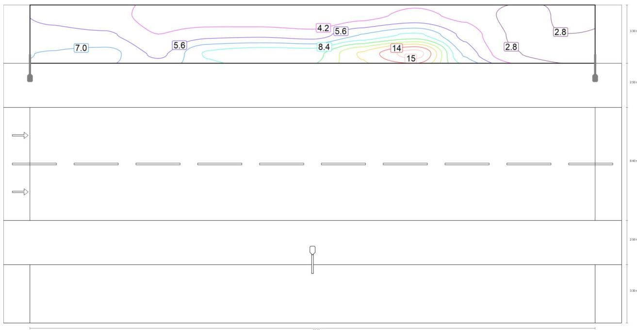
Valor de mantenimiento iluminancia semicilíndrica (oeste) [ $I_x$ ] (Líneas Isolux)
