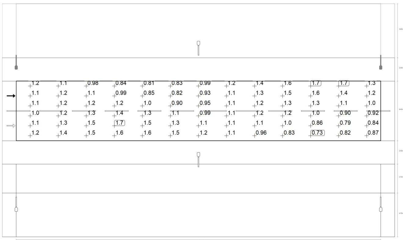
Observador 2: Valor de mantenimiento luminancia en calzada seca [cd/m<sup>2</sup>] (Sistema de valores)
