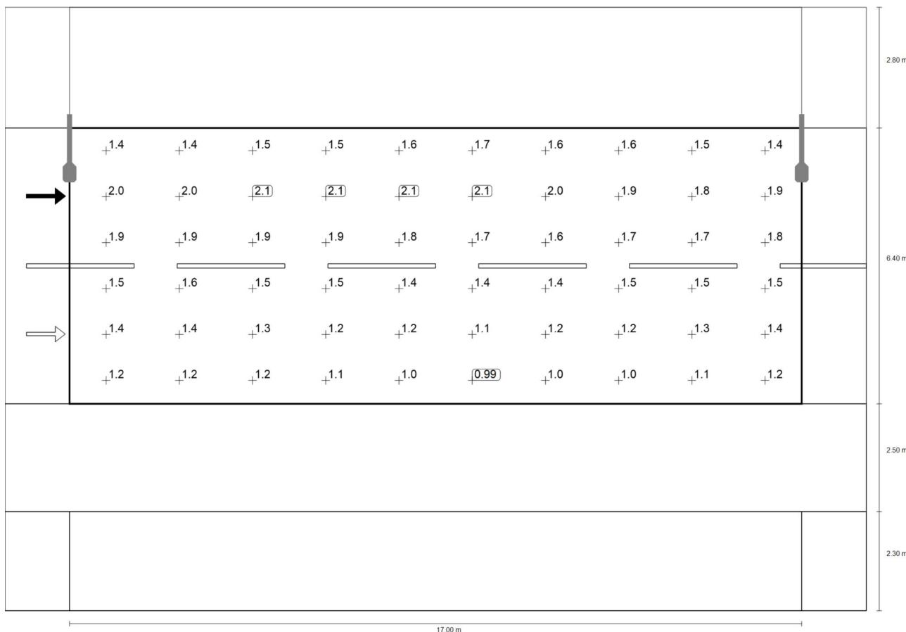
Observador 2: Valor de mantenimiento luminancia en calzada seca [cd/m<sup>2</sup>] (Sistema de valores)
