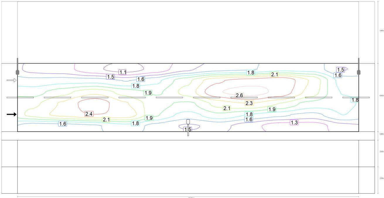
Observador 1: Valor de mantenimiento luminancia en calzada seca [cd/m<sup>2</sup>] (Líneas Isolux)
