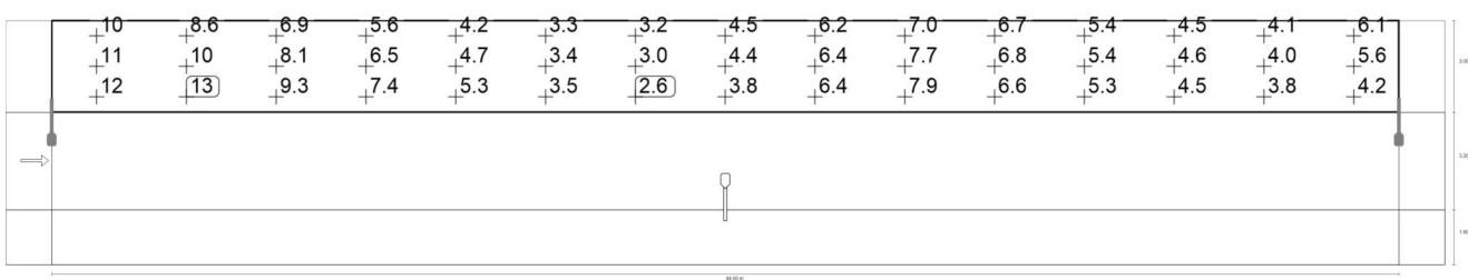
Valor de mantenimiento iluminancia semicilíndrica (oeste) [lx] (Sistema de valores)
