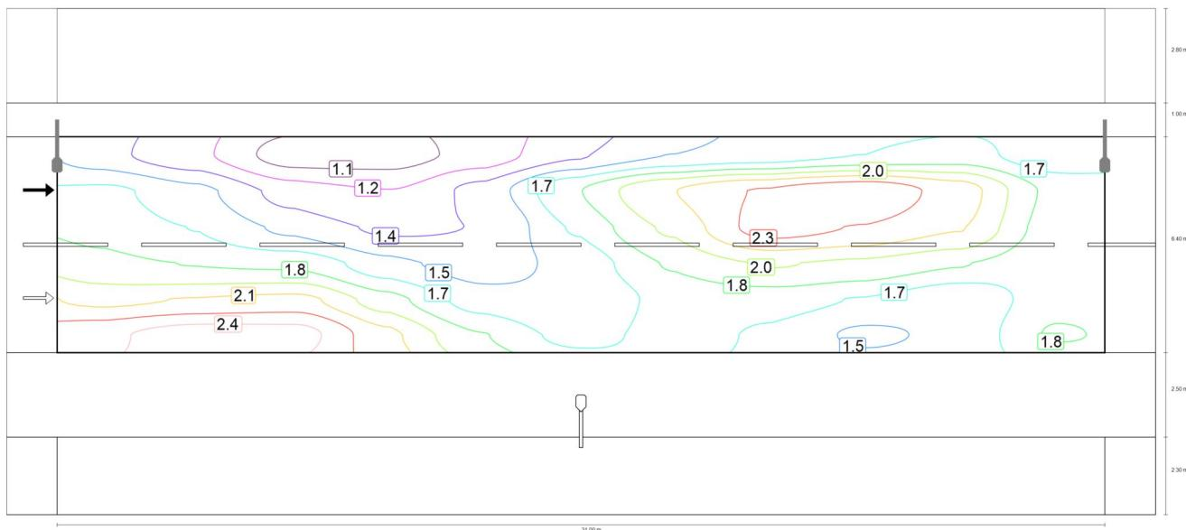
Observador 2: Valor de mantenimiento luminancia en calzada seca [cd/m<sup>2</sup>] (Líneas Isolux)
