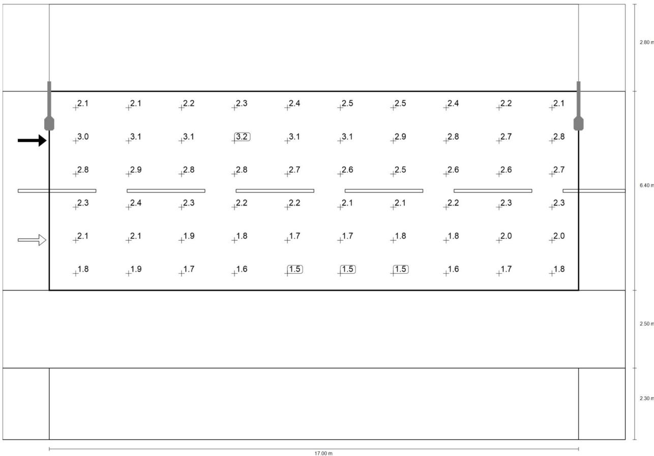
Observador 2: Luminancia para una instalación nueva [cd/m<sup>2</sup>] (Sistema de valores)
