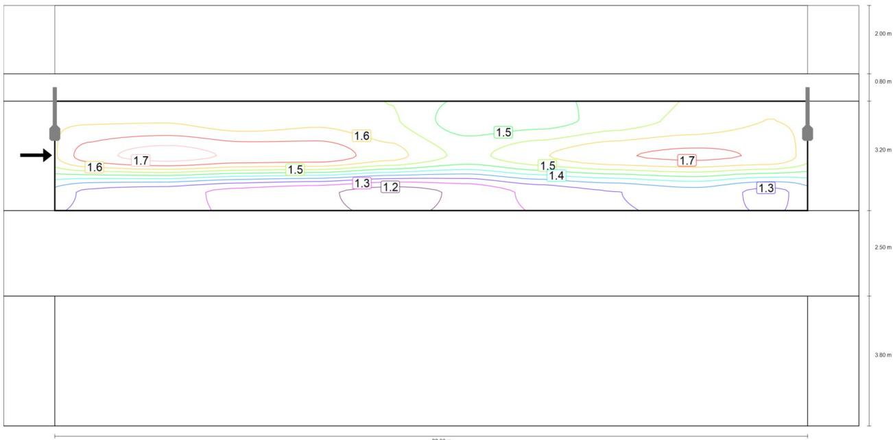
Observador 1: Valor de mantenimiento luminancia en calzada seca [cd/m<sup>2</sup>] (Líneas Isolux)
