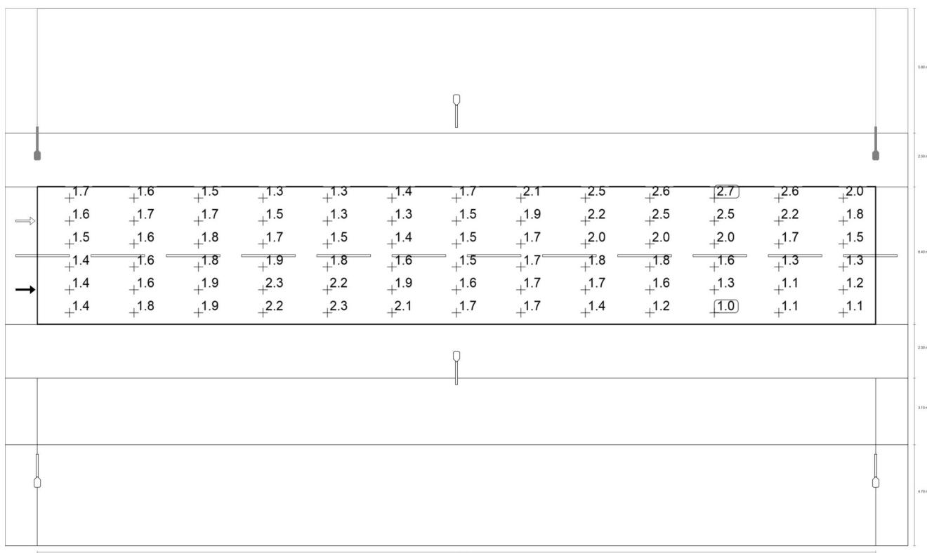
Observador 1: Luminancia para una instalación nueva [cd/m<sup>2</sup>] (Sistema de valores)
