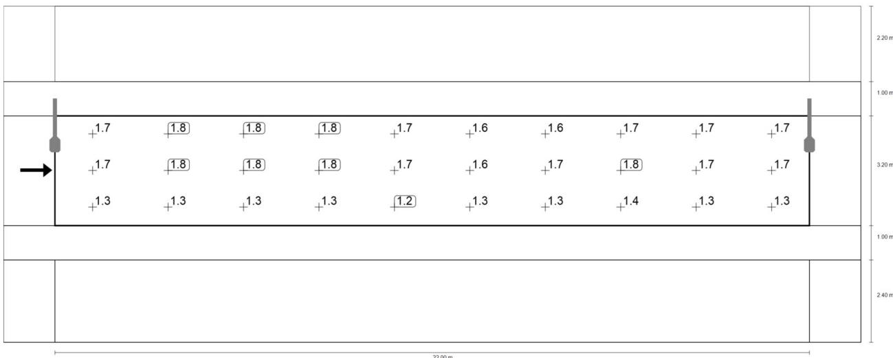
Observador 1: Valor de mantenimiento luminancia en calzada seca [cd/m<sup>2</sup>] (Sistema de valores)
