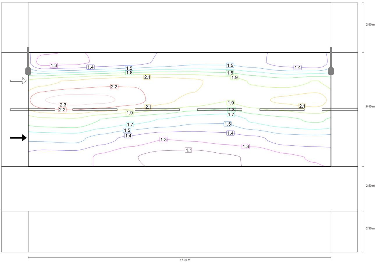
Observador 1: Valor de mantenimiento luminancia en calzada seca [cd/m<sup>2</sup>] (Líneas Isolux)
