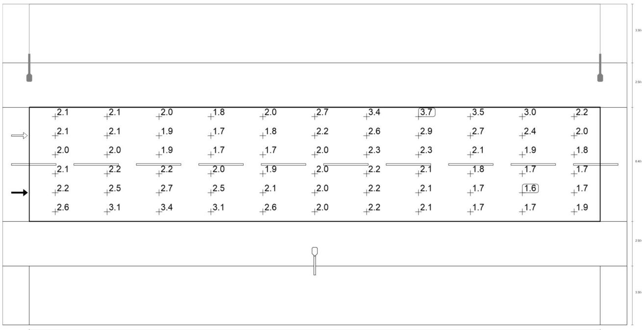
Observador 1: Luminancia para una instalación nueva [cd/m<sup>2</sup>] (Sistema de valores)
