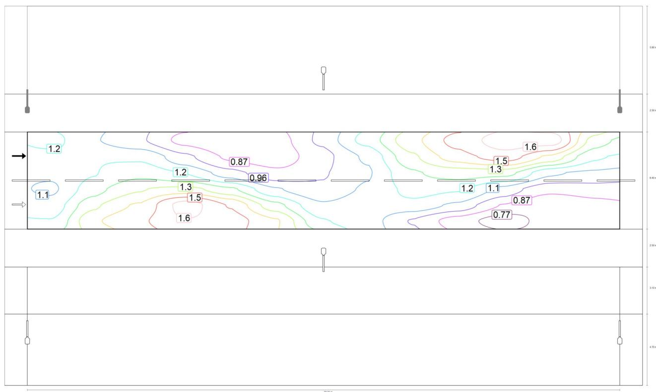
Observador 2: Valor de mantenimiento luminancia en calzada seca [cd/m<sup>2</sup>] (Líneas Isolux)
