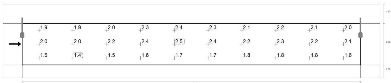
Observador 1: Luminancia para una instalación nueva [cd/m<sup>2</sup>] (Sistema de valores)
