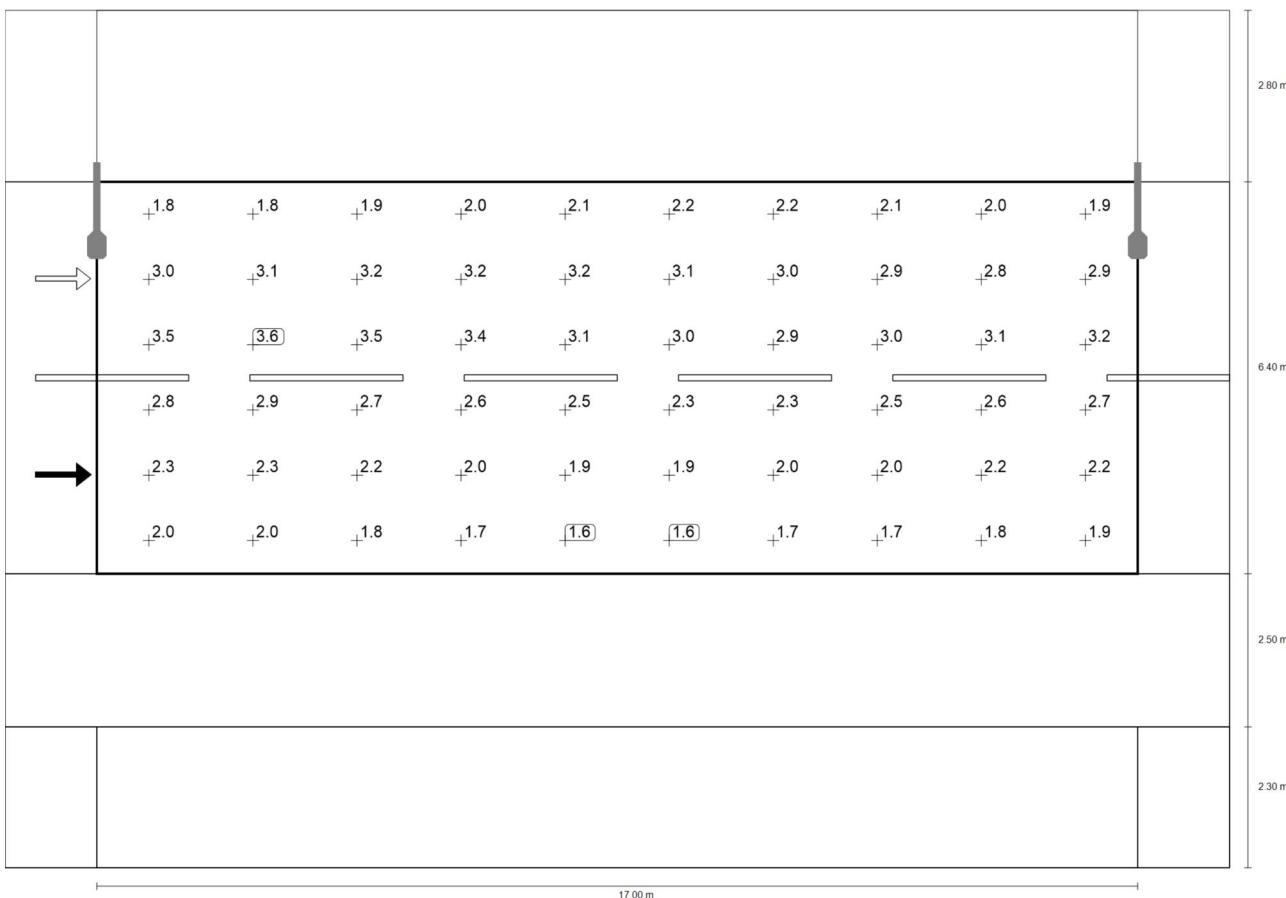
Observador 1: Luminancia para una instalación nueva [cd/m<sup>2</sup>] (Sistema de valores)
