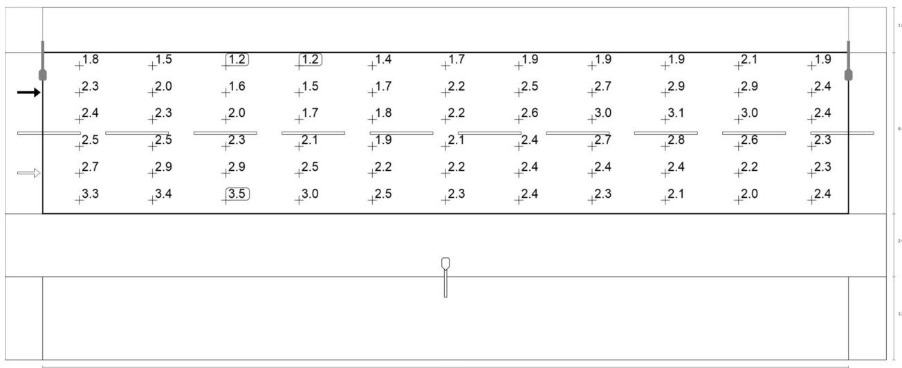
Observador 2: Luminancia para una instalación nueva [cd/m<sup>2</sup>] (Sistema de valores)
