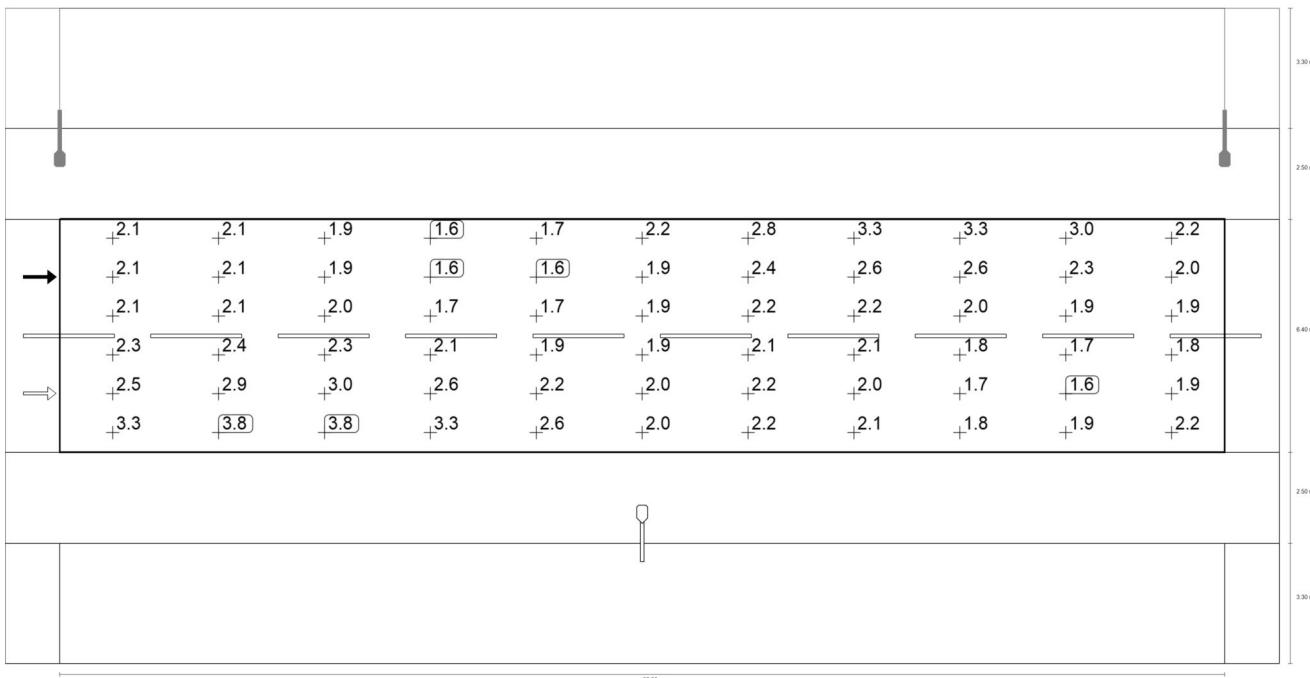
Observador 2: Luminancia para una instalación nueva [cd/m<sup>2</sup>] (Sistema de valores)
