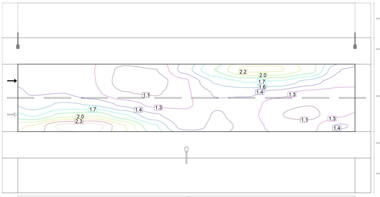
Observador 2: Valor de mantenimiento luminancia en calzada seca  $[\text{cd}/\text{m}^2]$  (Líneas Isolux)
