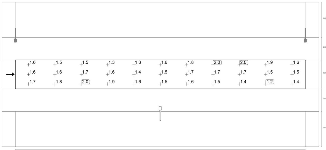
Observador 1: Valor de mantenimiento luminancia en calzada seca [cd/m<sup>2</sup>] (Sistema de valores)
