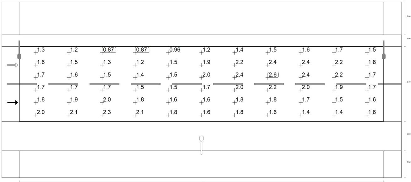
Observador 1: Valor de mantenimiento luminancia en calzada seca [cd/m<sup>2</sup>] (Sistema de valores)
