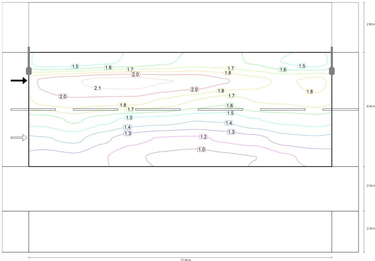
Observador 2: Valor de mantenimiento luminancia en calzada seca [cd/m<sup>2</sup>] (Líneas Isolux)
