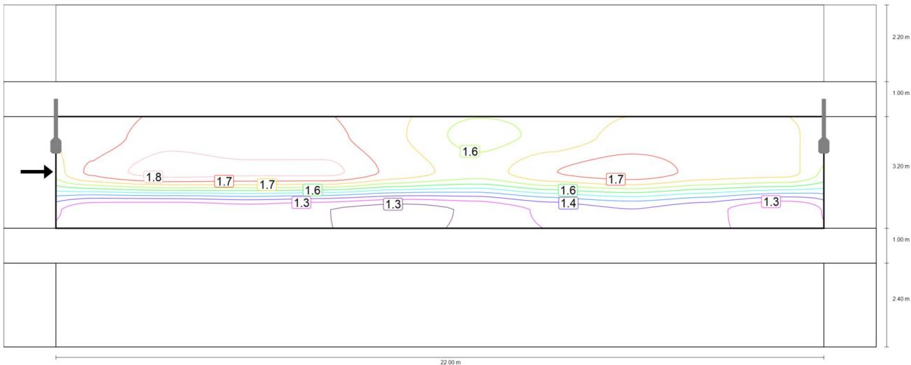
Observador 1: Valor de mantenimiento luminancia en calzada seca [cd/m<sup>2</sup>] (Líneas Isolux)
