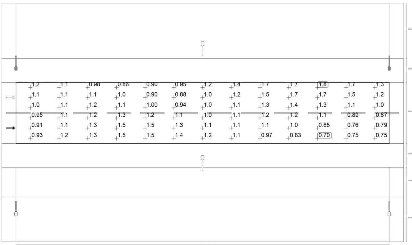
Observador 1: Valor de mantenimiento luminancia en calzada seca [cd/m<sup>2</sup>] (Sistema de valores)
