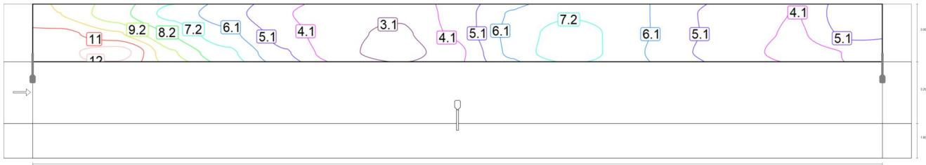
Valor de mantenimiento iluminancia semicilíndrica (oeste) [lx] (Líneas Isolux)
