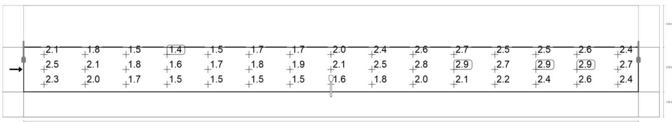
Observador 1: Luminancia para una instalación nueva [cd/m<sup>2</sup>] (Sistema de valores)
