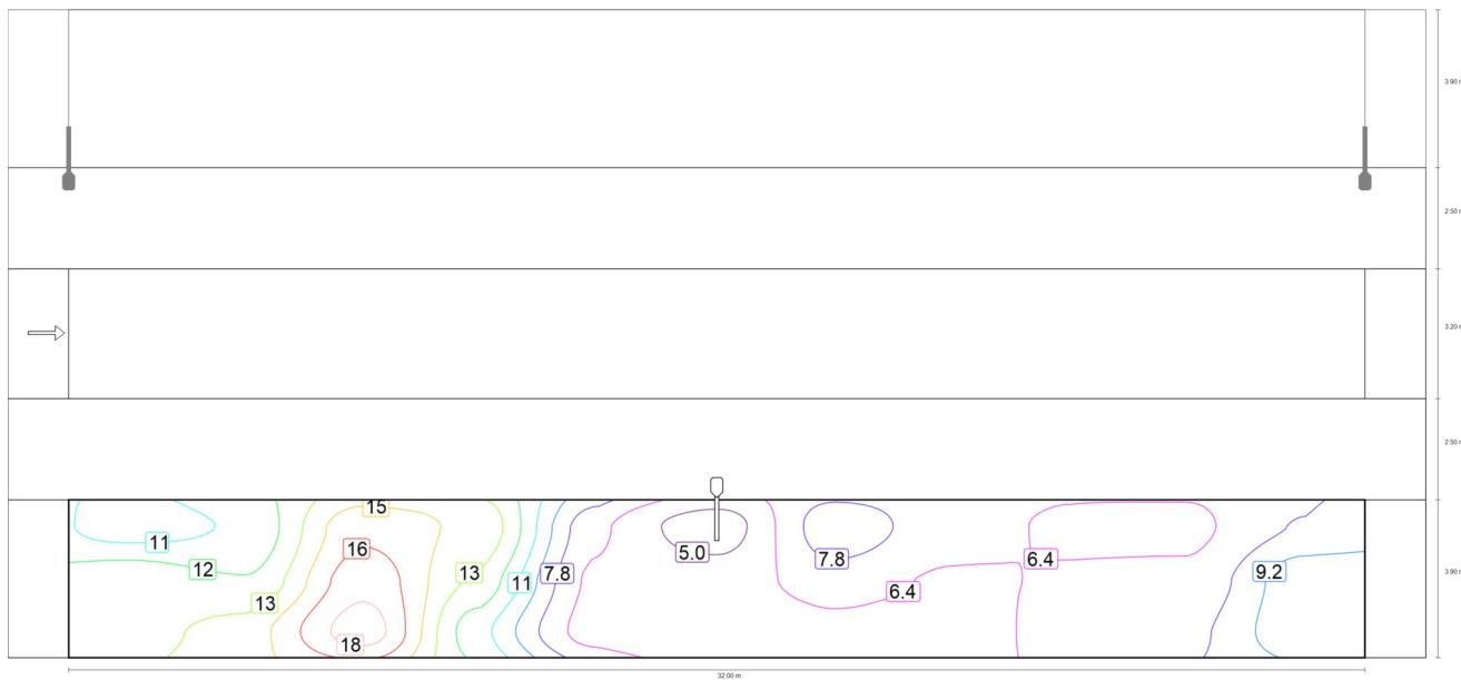
Valor de mantenimiento iluminancia semicilíndrica (oeste) [Ix] (Líneas Isolux)
