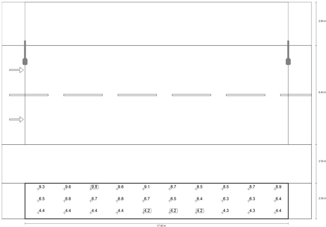
Valor de mantenimiento iluminancia semicilíndrica (oeste) [lx] (Sistema de valores)
