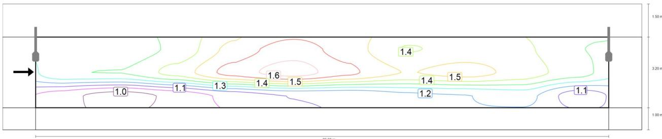
Observador 1: Valor de mantenimiento luminancia en calzada seca [cd/m<sup>2</sup>] (Líneas Isolux)
