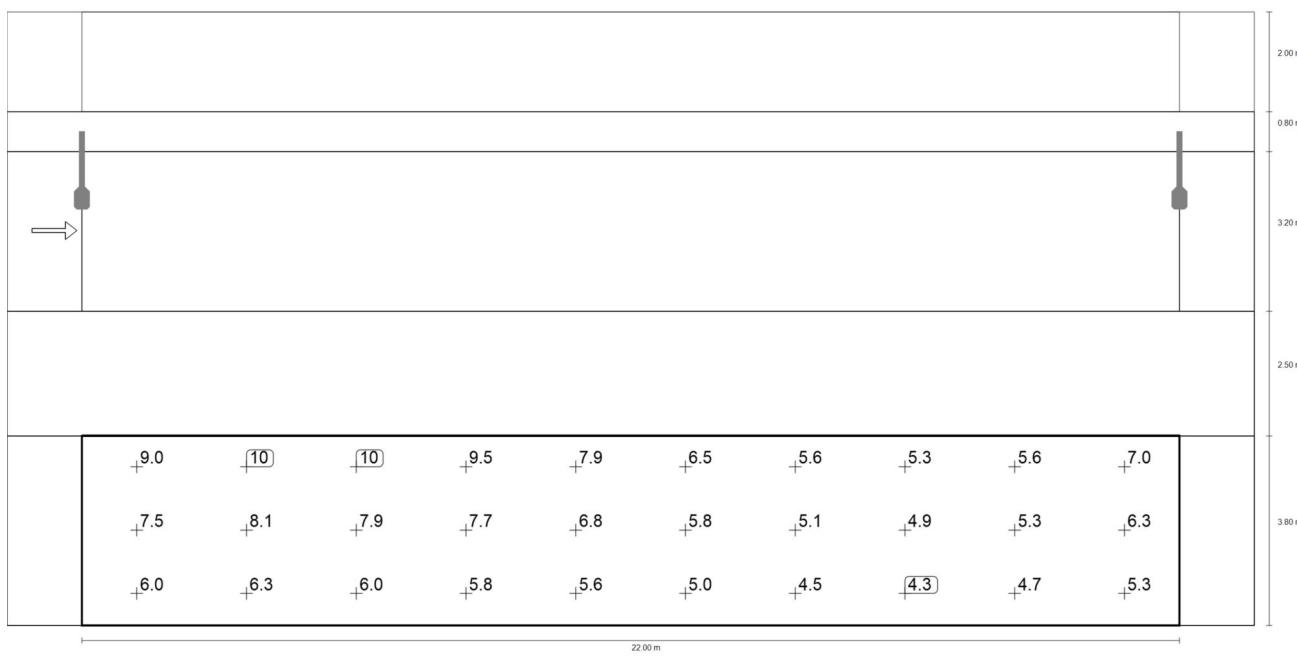
Valor de mantenimiento iluminancia semicilíndrica (oeste) [ $I_x$ ] (Sistema de valores)
