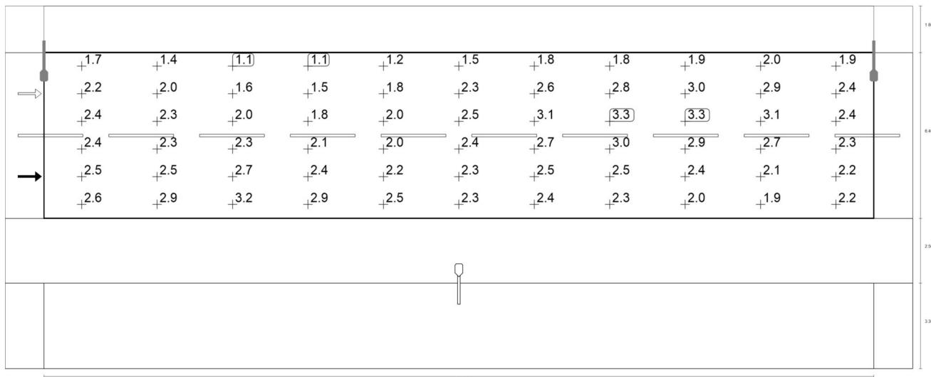
Observador 1: Luminancia para una instalación nueva [cd/m<sup>2</sup>] (Sistema de valores)
