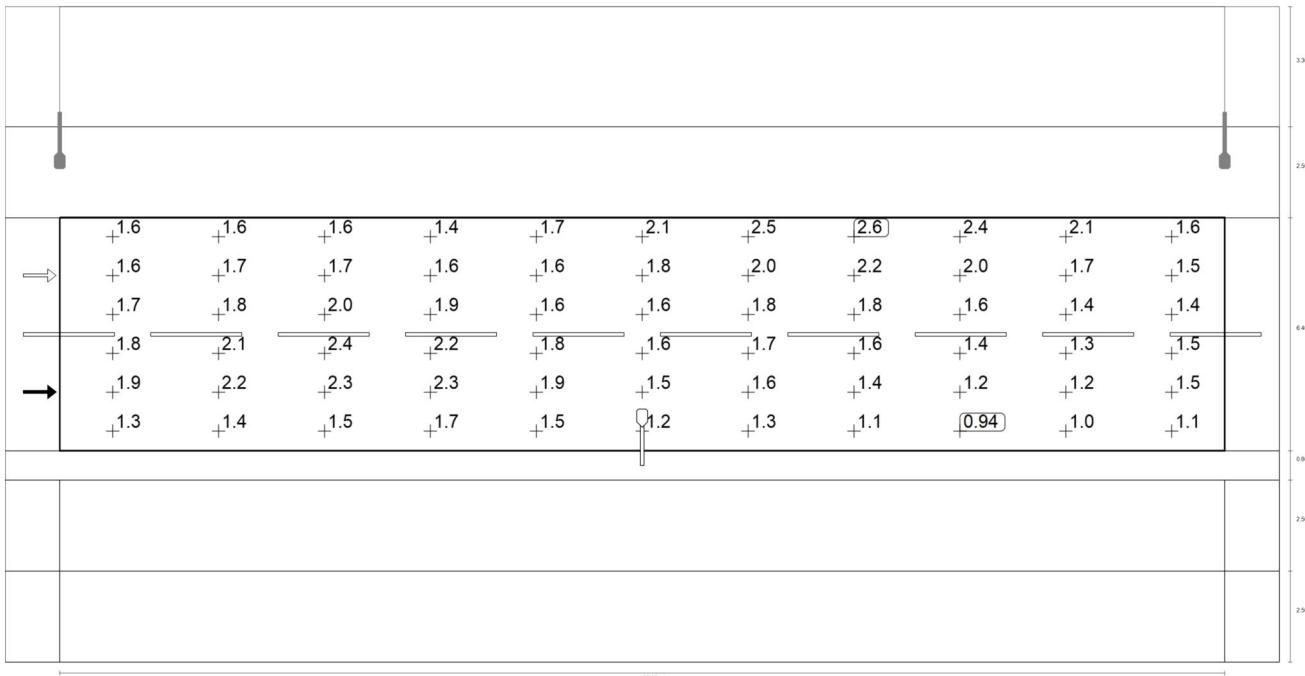
Observador 1: Valor de mantenimiento luminancia en calzada seca [cd/m<sup>2</sup>] (Sistema de valores)
