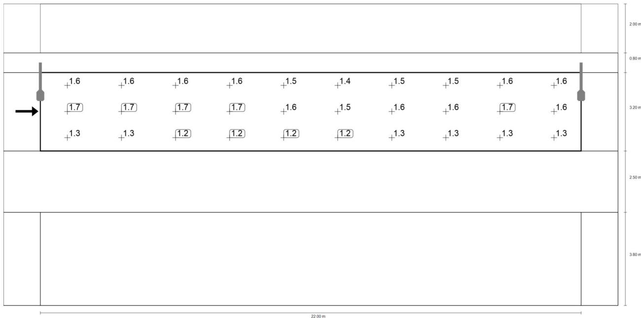
Observador 1: Valor de mantenimiento luminancia en calzada seca [ $\text{cd}/\text{m}^2$ ] (Sistema de valores)
