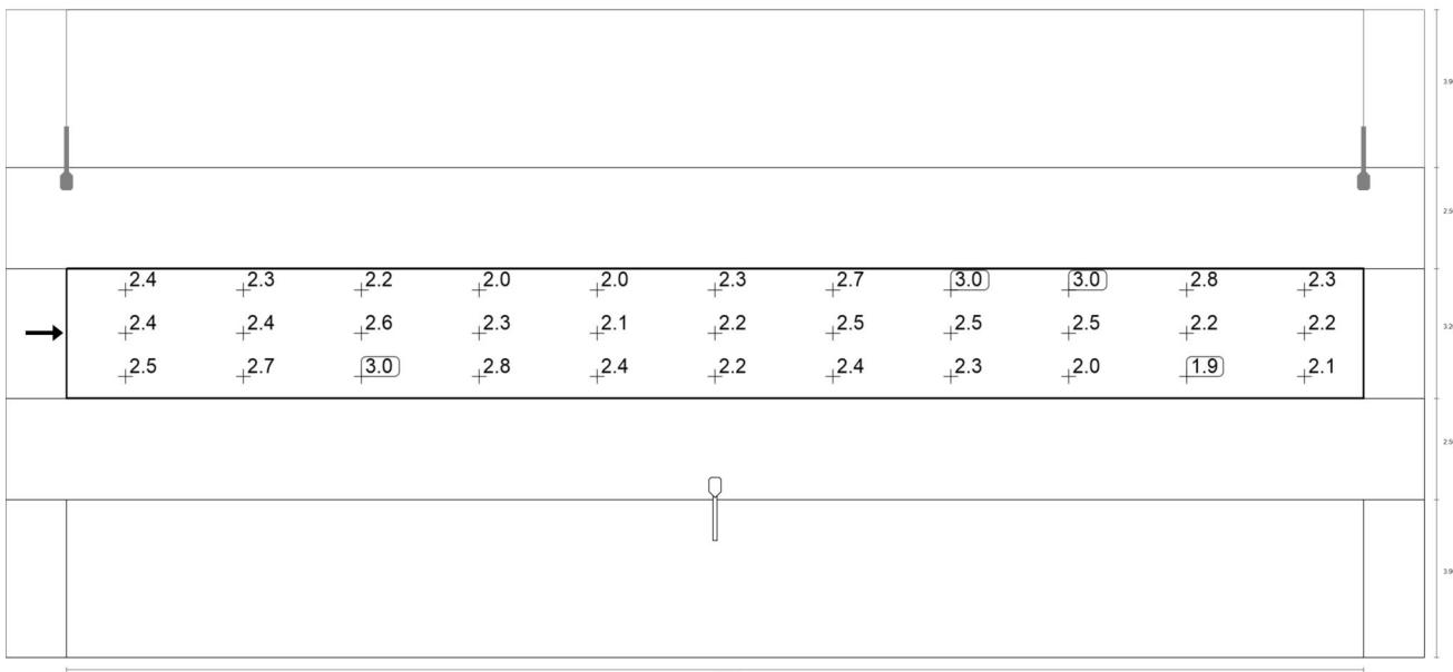
Observador 1: Luminancia para una instalación nueva [cd/m<sup>2</sup>] (Sistema de valores)
