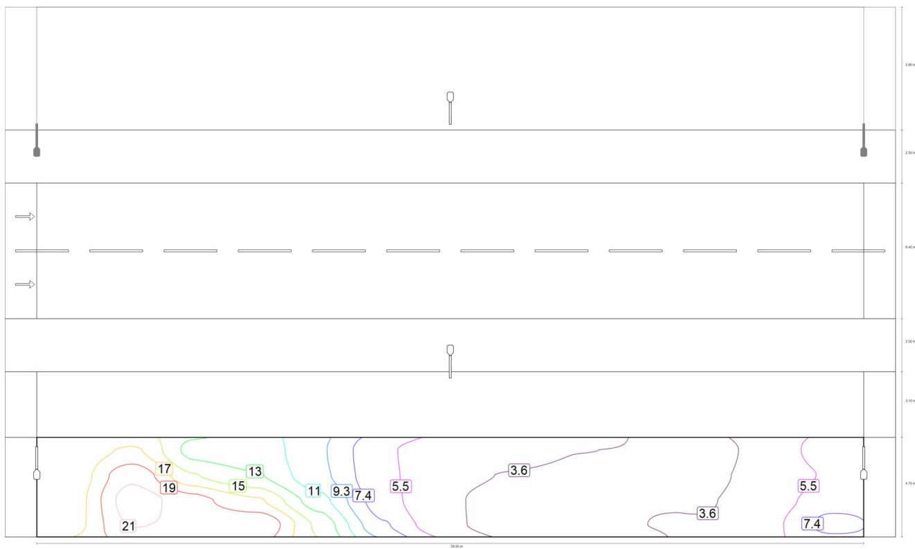
Valor de mantenimiento iluminancia semicilíndrica (oeste) [lx] (Líneas Isolux)
