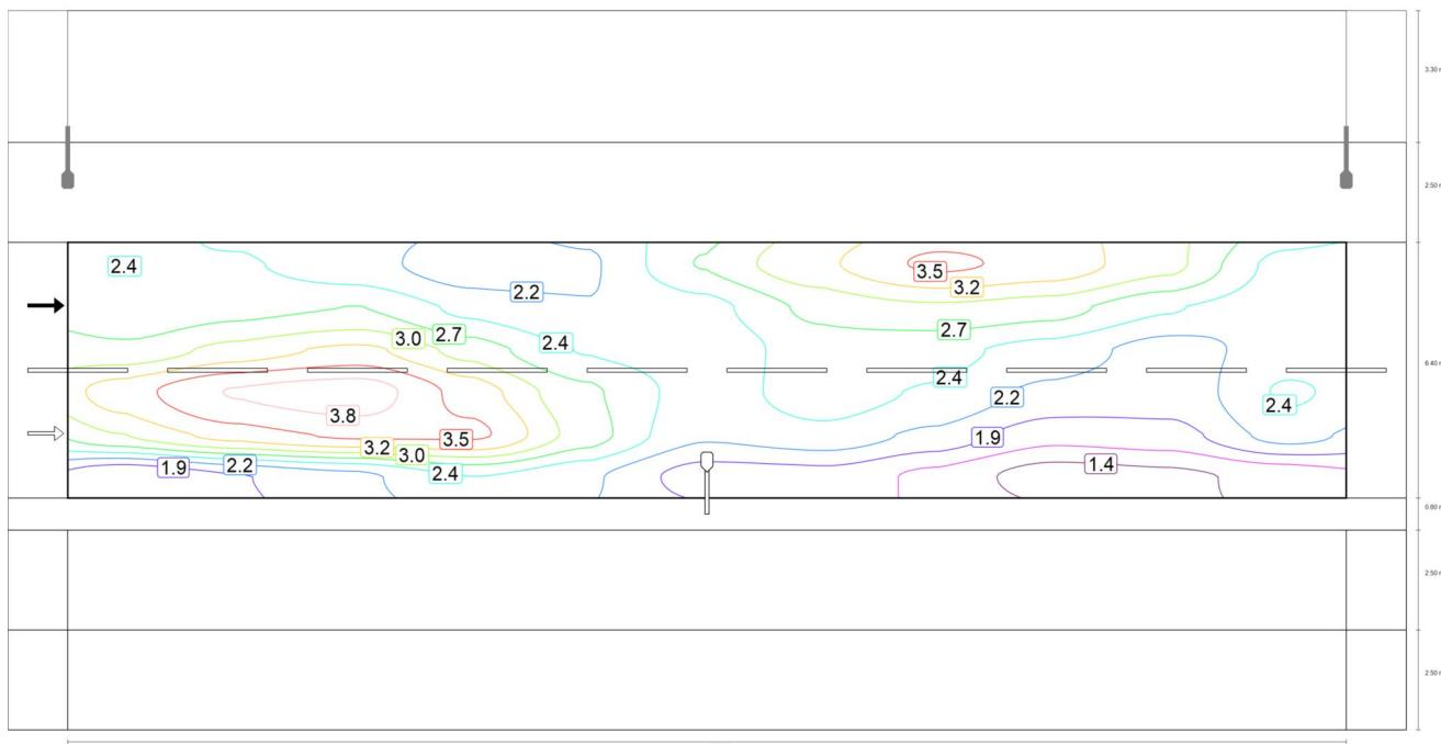
Observador 2: Luminancia para una instalación nueva [ $\text{cd}/\text{m}^2$ ] (Líneas Isolux)
