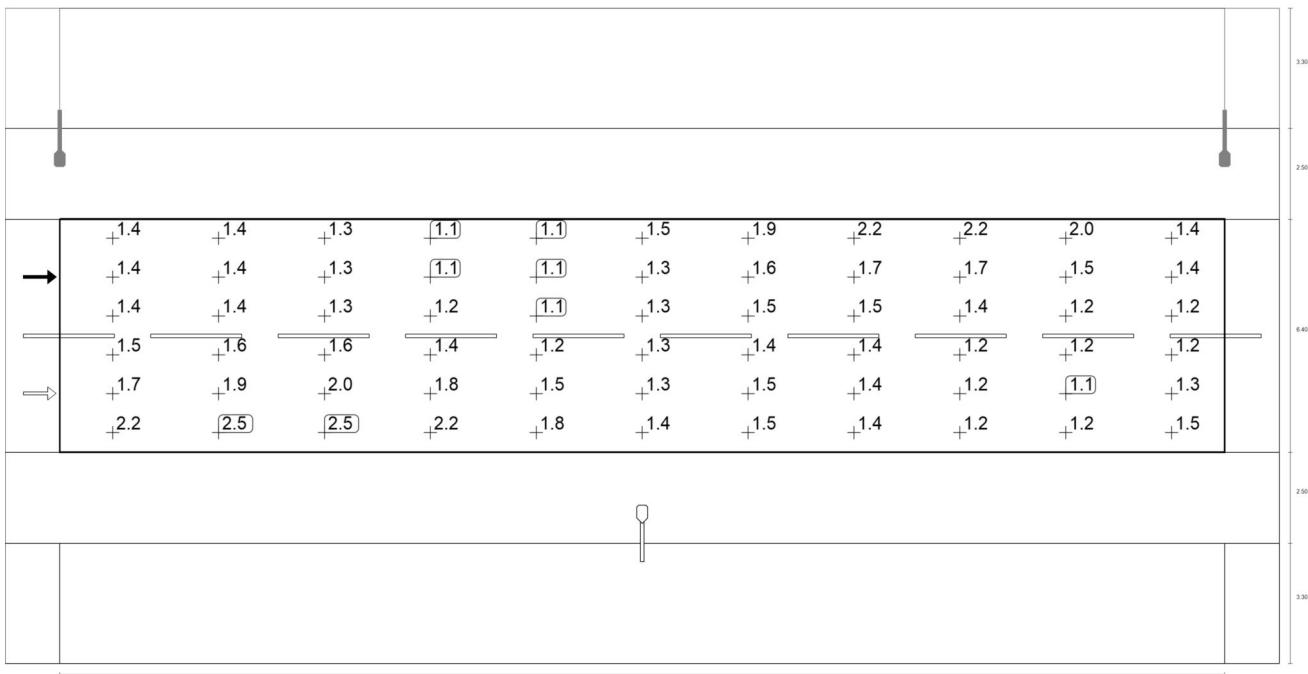
Observador 2: Valor de mantenimiento luminancia en calzada seca [cd/m<sup>2</sup>] (Sistema de valores)
