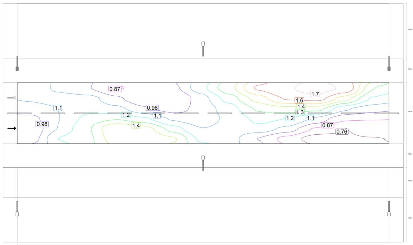
Observador 1: Valor de mantenimiento luminancia en calzada seca [cd/m<sup>2</sup>] (Líneas Isolux)
